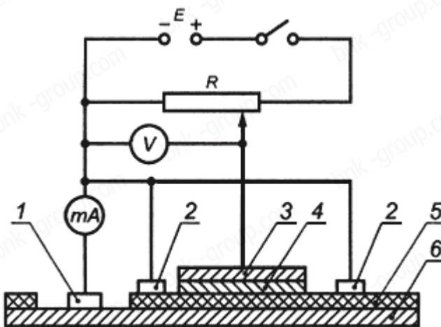
1 - контакт с трубой; 2 - экранирующие кольцевые электроды-бандажи; 3 - кольцевой электрод-бандаж; 4 - тканевое полотенце; 5 - изоляционное покрытие трубы; 6 - стенка трубы; Е - источник постоянного тока; R - потенциометр; V - высокоомный вольтметр; mA - миллиамперметр
