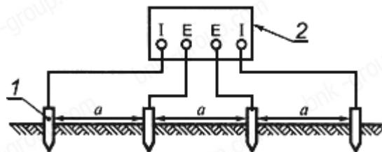
1 - электрод, 2 - прибор с клеммами: I - силы тока; E - напряжения;  $a$  - расстояние между электродами (см. формулу (A.1))
