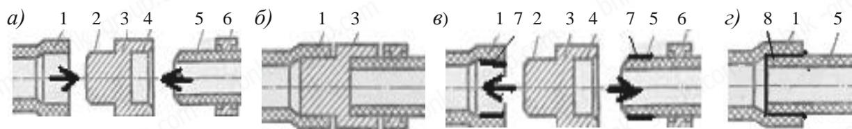
*а* – введение нагревателя; *б* – оплавление концов труб; *в* – выведение оплавленных труб из нагревателя; *г* – соединение труб; *д* – соединение труб; 1 – раструб; 2 – дорн; 3 – нагревательный элемент; 4 – гильза; 5 – гладкий конец; 6 – хомут; 7 – оплавленные поверхности; 8 – сварной шов (стрелками показано направление перемещения свариваемых трубных деталей)
