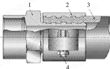
1 – штуцер с монтажным шестигранником и резьбовым хвостовиком; 2 – обжимной хомут; 3 – труба из ПЭ-С; 4 – стяжной болт с гайкой
