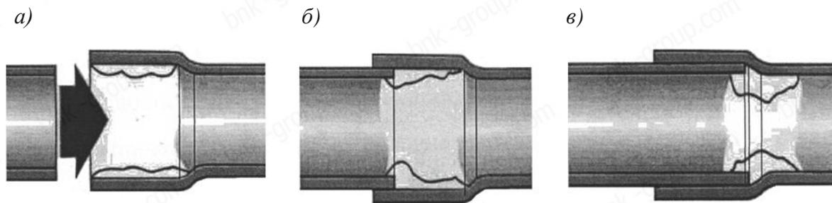
*а* – нанесение флюса на внутреннюю поверхность раструба перед пайкой; *б* – продвижение флюса по раструбу; *в* – переход раструба в трубопровод
