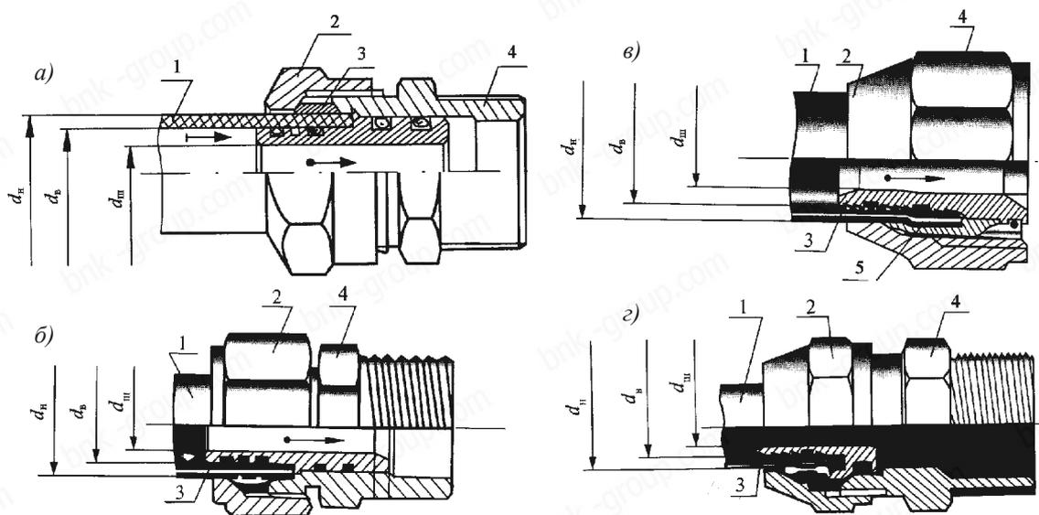
а – схема соединения металлополимерных труб; б – схема соединения с разрезным кольцом; в – соединение с неразрезным уплотнительным кольцом; г – схема соединения типа «евроконус»; 1 – пластмассовая или металлопластмассовая труба; 2 – накидная гайка; 3 – штуцер; 4 – переходной элемент; 5 – неразрезное кольцо;  $d_{ш}$  – внутренний диаметр штуцера;  $d_{н}$ ,  $d_{в}$  – наружный и внутренний диаметры трубы;  $\rightarrow$  – направление движения воды (жидкости)
