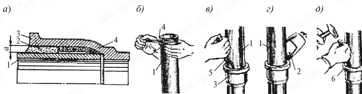
*а* – соединение в разрезе; *б* – подмотка смоляного каната; *в* – конопатка каната; *г* – заливка цементного раствора; *д* – чеканка цементного раствора; *1* – гладкий конец трубы; *2* – цемент; *3* – раструб; *4* – смоляная прядь; *5* – конопатка; *6* – чеканка
