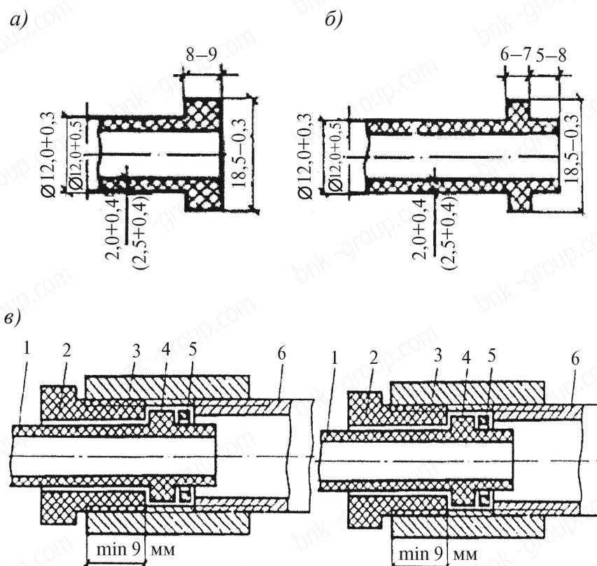
*a* – с формованным утолщенным буртом под накидную гайку; *б, в* – с наплавляемым (литым) утолщенным буртом; *б* – под накидную гайку, *в* – под футорку; *1* – подводка из ПВД; *2* – футорка; *3* – муфта чугунная  $D_y = 15$  мм; *4* – наплавленный бурт; *5* – резиновая прокладка; *6* – стальная труба  $D_y = 15$  мм
