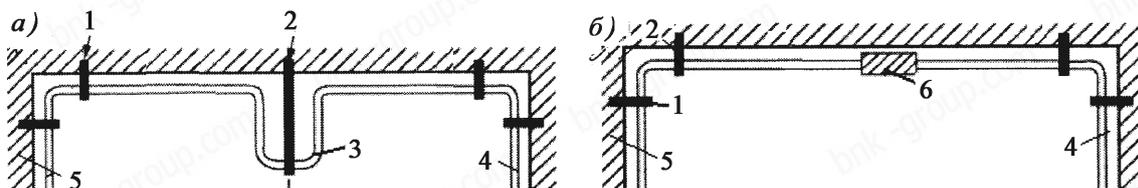
а – с П-образным компенсатором; б – с сифонным кмпенсатором; 1 – неподвижная опора; 2 – подвижная опора; 3 – П-образный компенсатор; 4 – трубопровод; 5 – стена; б – сифонный компенсатор
