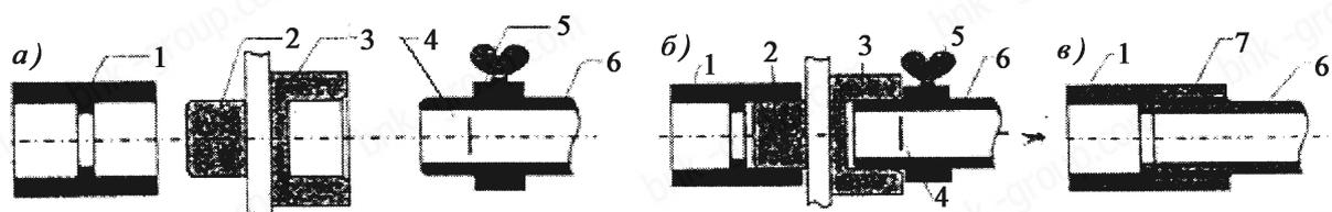
*a* – подготовка к сварке; *б* – оплавление свариваемых поверхностей; *в* – сопряжение трубы и муфты; 1 – муфта; 2 – дорн нагревательного устройства; 3 – гильза нагревательного устройства; 4 – метка на внешней поверхности конца трубы; 5 – ограничительный хомут; 6 – труба; 7 – сварной шов
