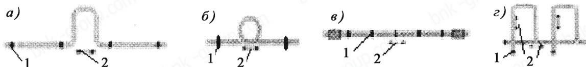
Компенсаторы: а – П-образный; б – круговой; в – сифонный; г – угловой; 1 – подвижное крепление; 2 – направления перемещения
