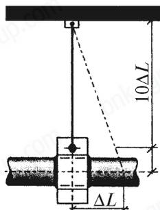
Рисунок 8.12 – Крепление водопровода из медных труб хомутом на подвеске, учитывающей температурные перемещения
