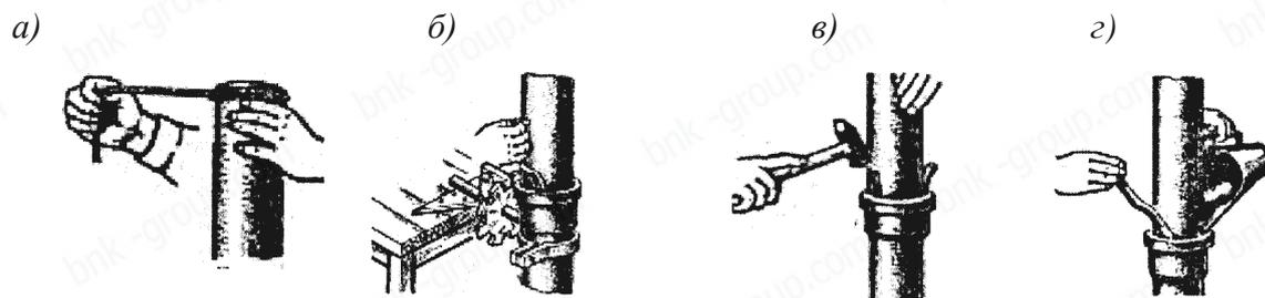
*а* – намотка жгута; *б* – конопатка жгута; *в* – центровка трубы; *г* – заливка цементного раствора
