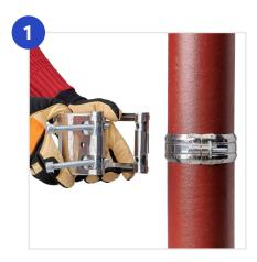
Предварительно разожмите усиливающий хомут и наденьте так, чтобы обе его половины равномерно охватывали концы труб (фитингов), а зубья не соприкасались с первым хомутом Rapid «САПСАН».
