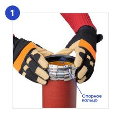
Наденьте хомут на трубу (фитинг) таким образом, чтобы конец трубы уперся в центральное внутреннее опорное кольцо уплотняющей втулки.
