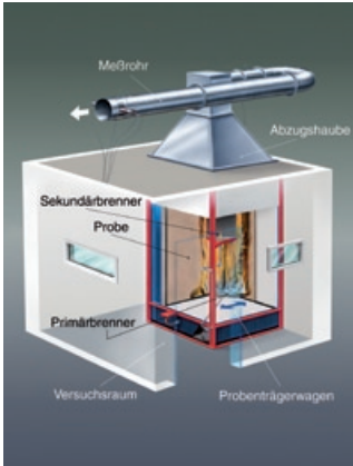
DIN EN 20187 normuna göre deneysel kurulum
