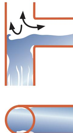
Es wurde festgestellt, dass zur Funktion einer Falleitung erhebliche Luftvolumenströme erforderlich sind. So werden zum Beispiel bei einer Falleitung DN 100 und einer Abwasserbelastung von 100 l/min. insgesamt 2340 l/min. Luft mitgeführt.
